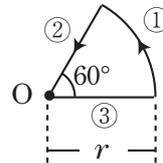
例えば、上図のような扇形の電流が、点Oに作る磁界の大きさ  $H$  を問われた場合、導出を経験している人なら、「点Oに磁界を作るのは円弧①の電流だけであり、辺②、③の部分は点Oに磁界を作らない」という点が理解出来ると思います。
